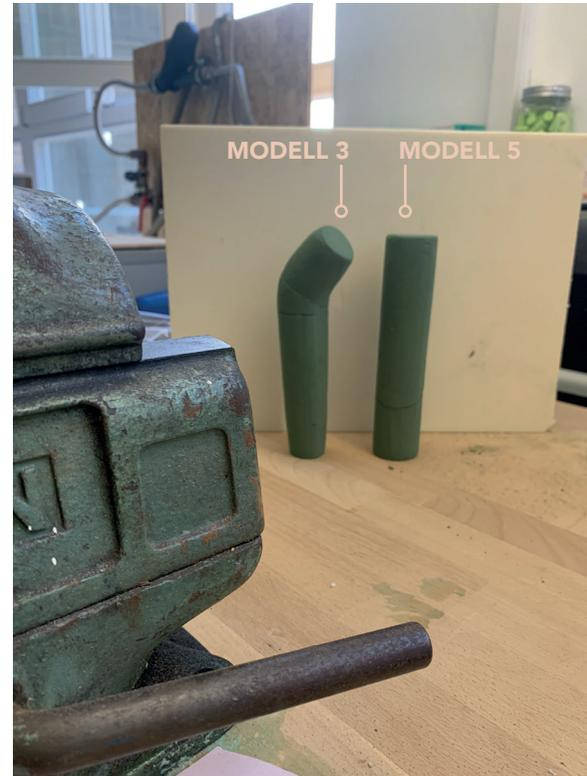
In der Handhabung überzeugte das Modell 3 mit der konischen Form. Die Funktion des Drehens und die breitere Strahlmatte gefiel in Modell 5. Ebenso, der prägnante Winkel in der verdrehten Position.
