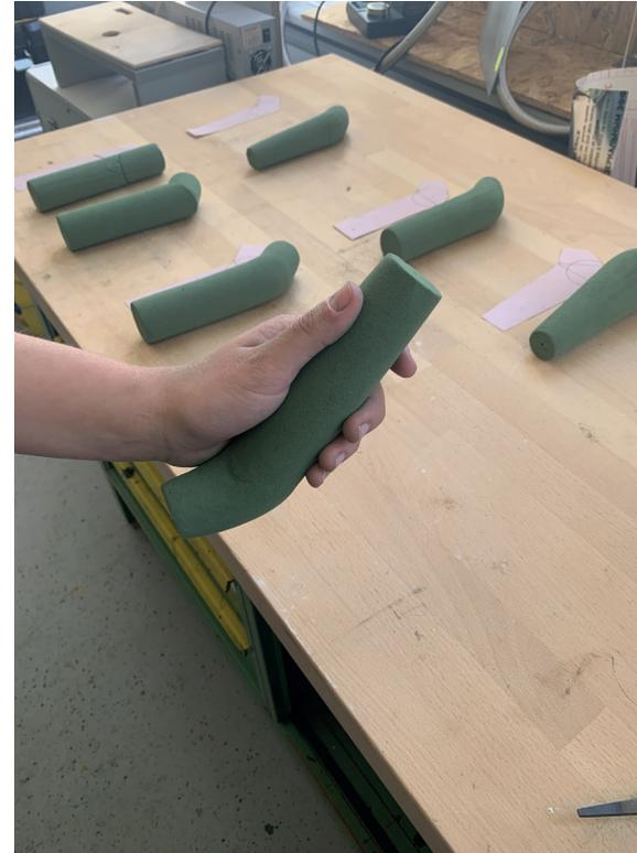
Das Modell 3 überzeugte in beiden Haltemöglichkeiten. Der starke Radius am Winkel und der Durchmesser an der Strahlmatte wurde jedoch bemängelt.
